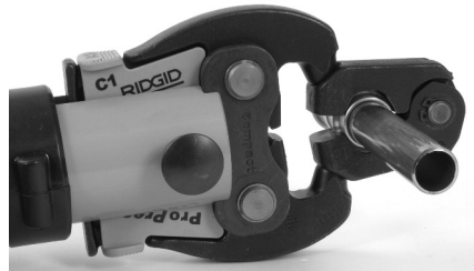
Figura 10 – Montaje del accionador en el aro sellador
