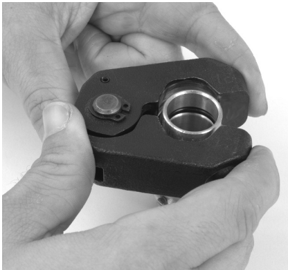
Figura 9 – Montaje del aro sellador en el acoplamiento
